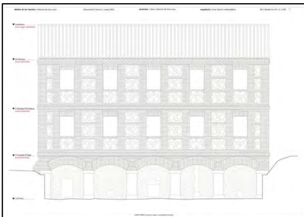
Vista sur del molino, hacia la salida de aguas. Proyecto de rehabilitación.
