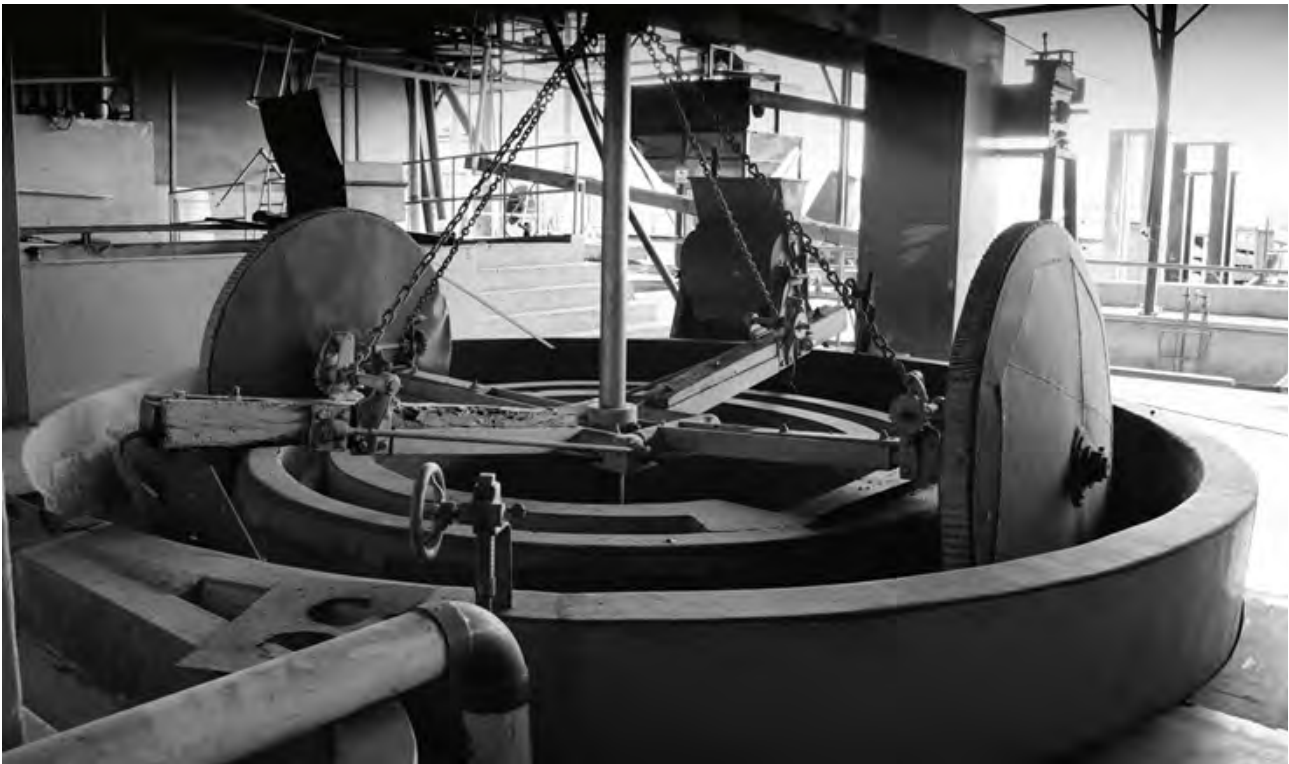
Figura 1. Chancadora o despulpador circular de piedra. Fotografía por los autores, Beneficio Patalillo. Tres Ríos, Cartago, 2019.
