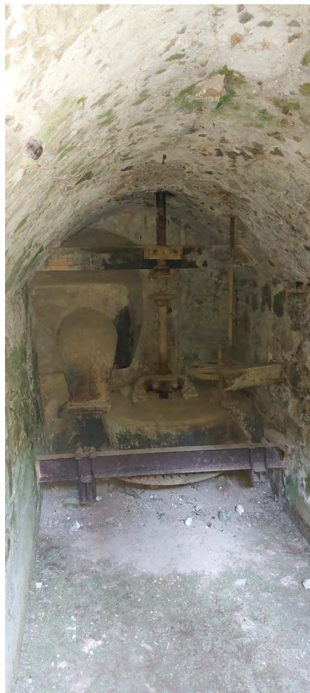
Fig. 6. Turbina Molino de Ayapango 2021. Se observa la turbina al interior del cárcavo del Molino de Ayapango. Fotografía de Hector Perea Chairez.
