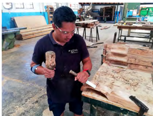
Construcción de un álabe
