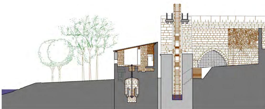
Imagen 6. Plano de sección transversal del norial del monasterio de Rueda. Autor: Javier Ibargüen Soler.
