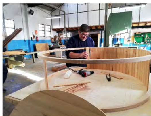
Construcción del guardapolvo
