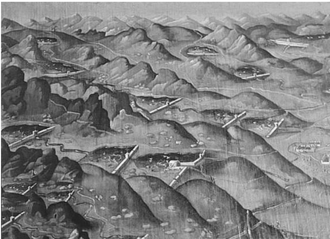
Fig. 4. Lagunas artificiales en el Kari Kari. Nótese aquí la interconexión de las lagunas mediante canales. Imagen: Vista general de Potosí. Óleo de Gaspar Miguel de Berrío. Siglo XVIII. Museo Nacional. Sucre. (Fuente: El mundo desde Potosí: www.cervantesvirtual.com )
