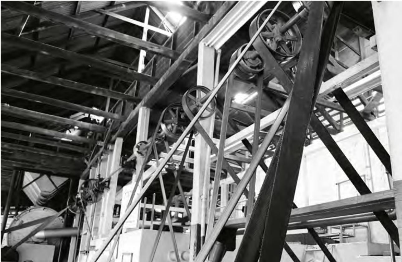
Figura 4. Eje de distribución de movimiento. Fotografía por los autores en Beneficio Finca Doka Estate. Sabanilla de Alajuela, 2020.
