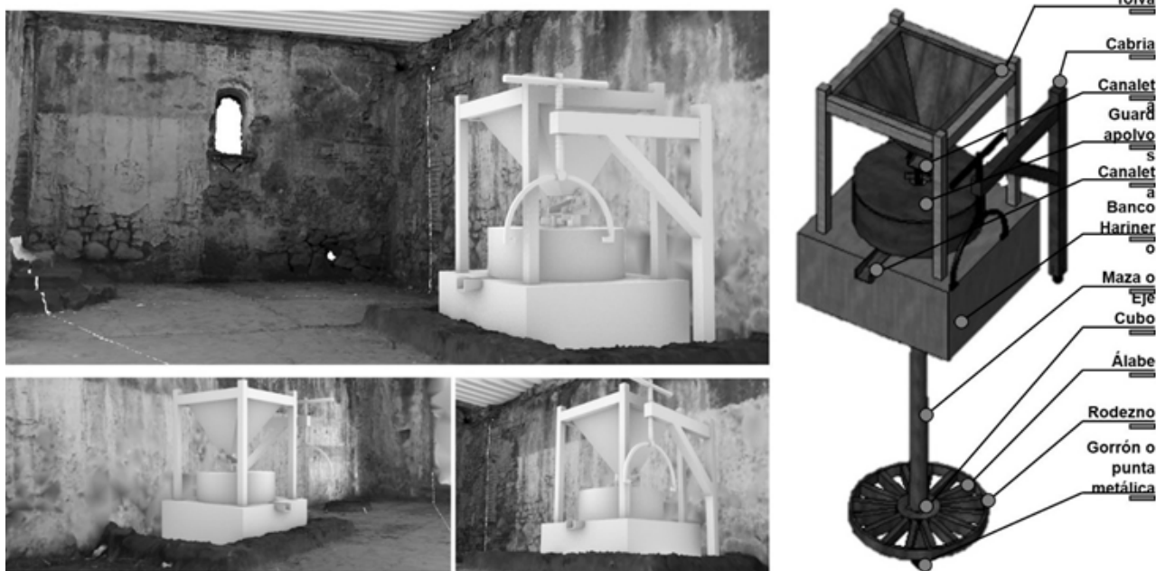
Imagen 7. Isométrico por medio de una fotogrametría del edificio principal del molino y modelado en 3D de la maquinaria. Capturas de imágenes: Eduardo López Carlos y el taller de Conservación del patrimonio Urbano Arquitectónico. Fecha de captura: 24 de febrero de 2020. Proceso de imágenes: Luis Cruz Ramírez. Modelado de la maquinaria: Eduardo López Carlos.
