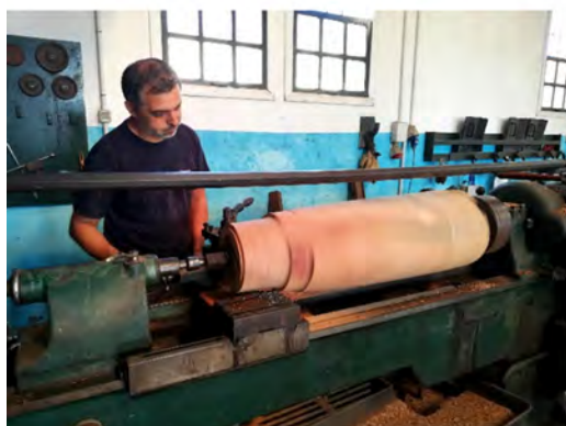
Construcción del árbol del rodete
