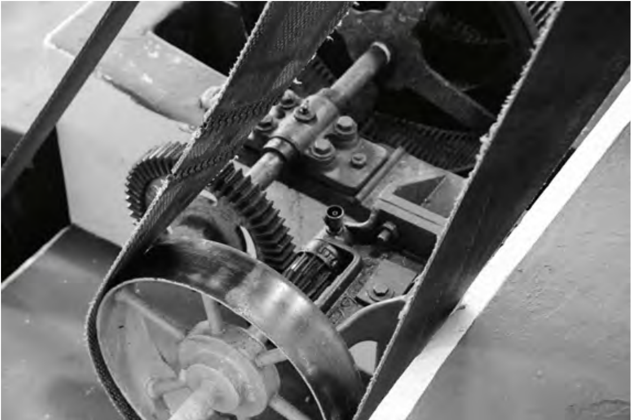
Figura 6. Detalle de correa de transmisión a engranaje. Fotografía por los autores en Beneficio Finca Doka State. Sabanilla de Alajuela, 2020.
