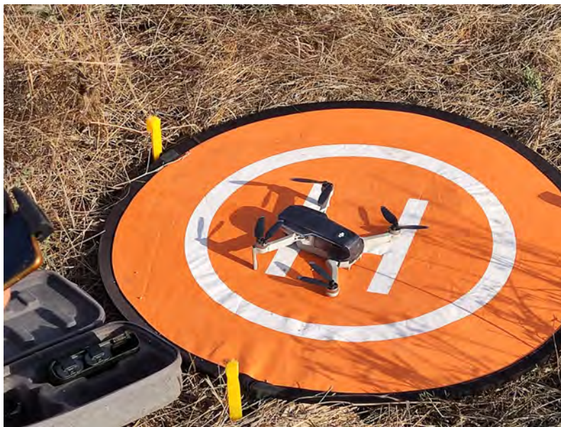
Figura nº 2. Dron empleado para llevar a cabo la fotogrametría. Fuente: Elaboración propia.
