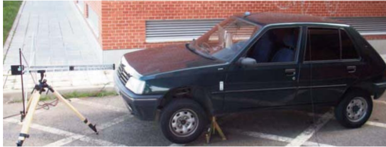
Figura 2: Antena EMCO 3142 en polarización horizontal, distancia 1m.
