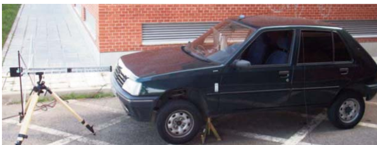
Figura 3: Antena EMCO 3142 en polarización horizontal, con centro encima de rejilla delantera.
